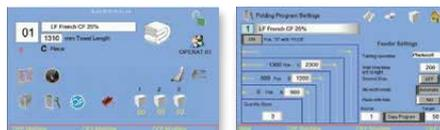
La piegaspugne **t.Towel** ha un PLC basato su controllo di sistema tramite un facile schermo touchscreen con 7 colori. Il sistema di controllo ha bisogno di un computer potente e pertanto TEXFINITY ha scelto un plc della OMRON. Questo potente processore permette di ottenere il massimo della precisione nella piegatura, testata con dei test comparativi. Grazie al touchscreen reattivo di alta risoluzione, diventa estremamente facile costruire o modificare i programmi di piegatura.
